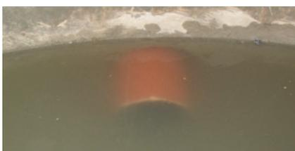
Wasserspiegel bei der Prüfung 50 mm über dem obersten Rohrscheitel
